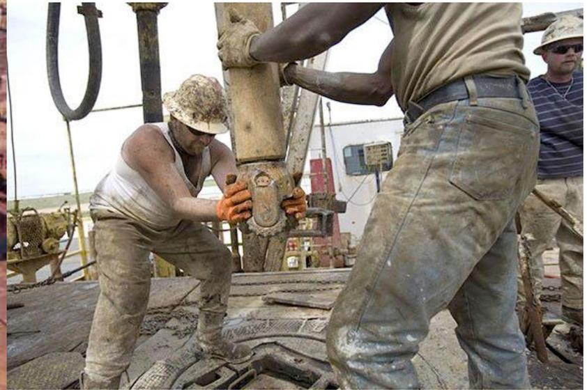
**La sonde est en pleine activité. Le maître sondeur à son poste surveille le cadran qui enregistre les réactions du trépan. Les hommes du plancher sont occupés au treuil ou à quelque mécanique. L'accrocheur attend dans le ciel la remontée des tiges pour aller se livrer, à de périlleuses acrobaties.**
