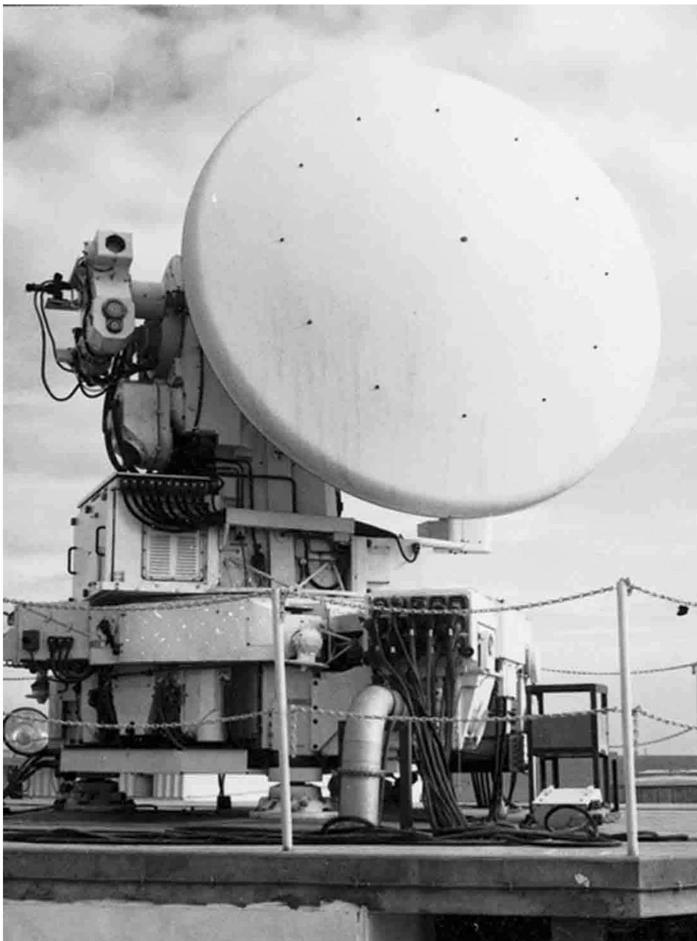
Radar de trajectographie Aquitaine capable de déterminer à 10 mètres près et à 0,1 millième de radian la position d'un satellite. Sa portée est de 3 000 kilomètres. Il est en relation avec les champs d'antennes AME
