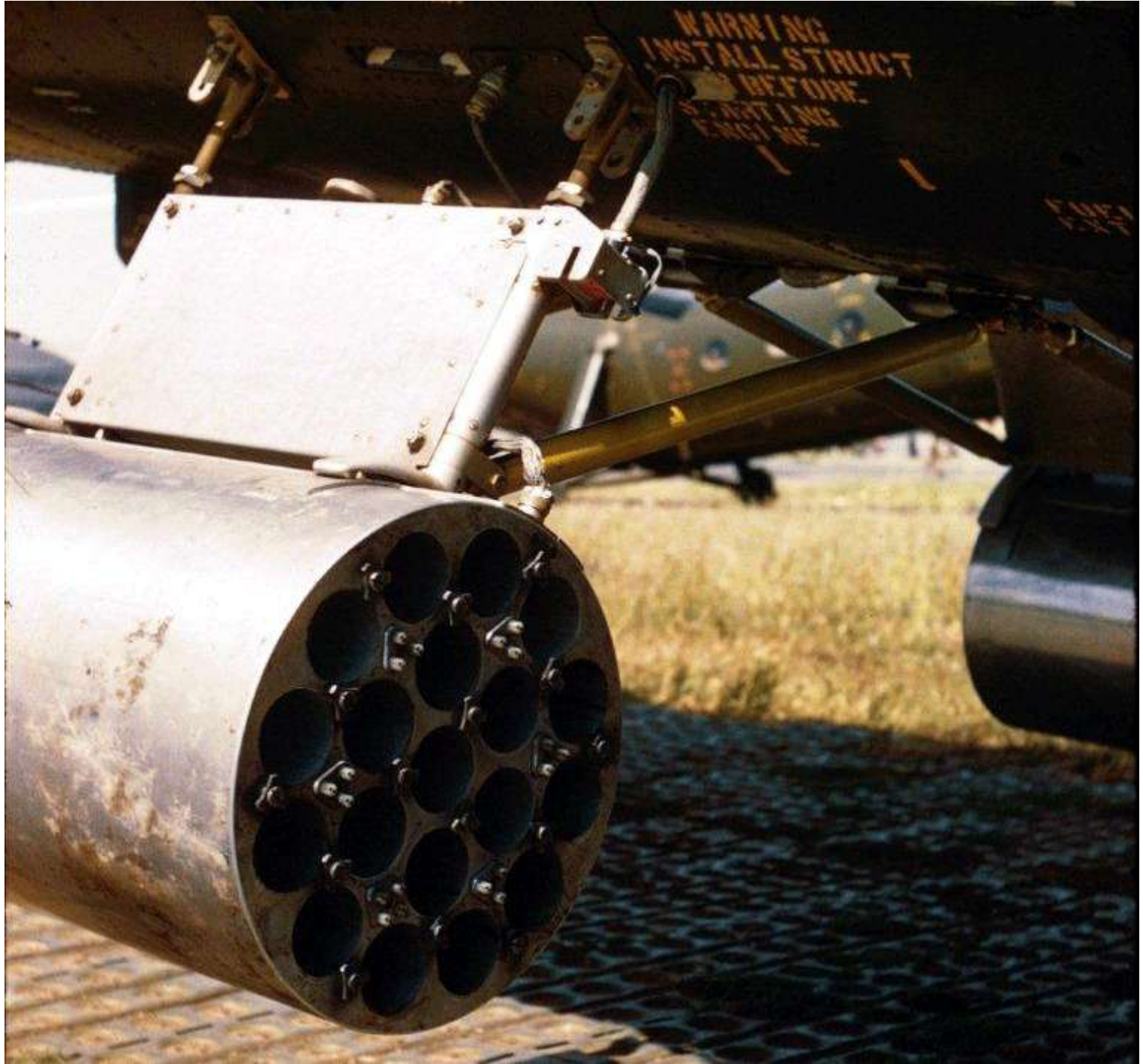
Vue rapprochée montrant le montage définitif des paniers MATRA 116 à 19 alvéoles de 68 mm. On note la présence des renforts obliques de réglage en jaune (photo Pierre GultzgoFF).
