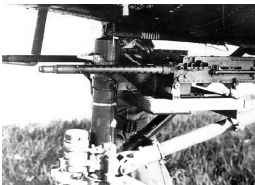
Vue de l'implantation des mitrailleuses de 0.30 sur le train avant des H-21 pendant l'expérimentation d'avril 1958 (photo X, via Emmanuel Bosc).
