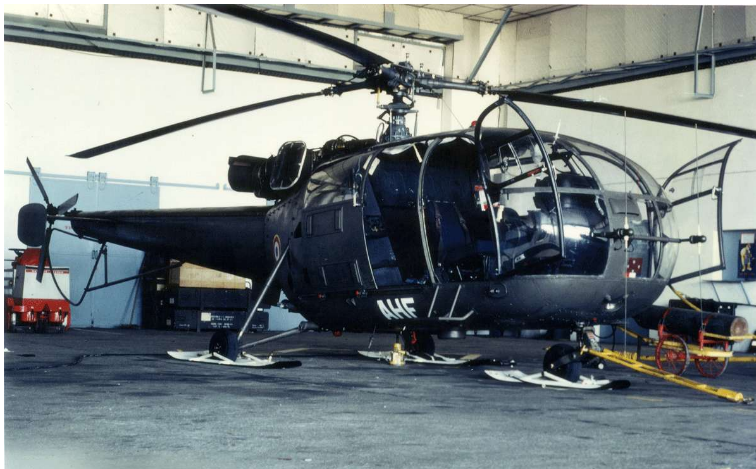
Alouette III n°1184/AHF du 5 e GHL, équipée d'atterrisseurs à skis (photo X, collection Christian Malcros).
