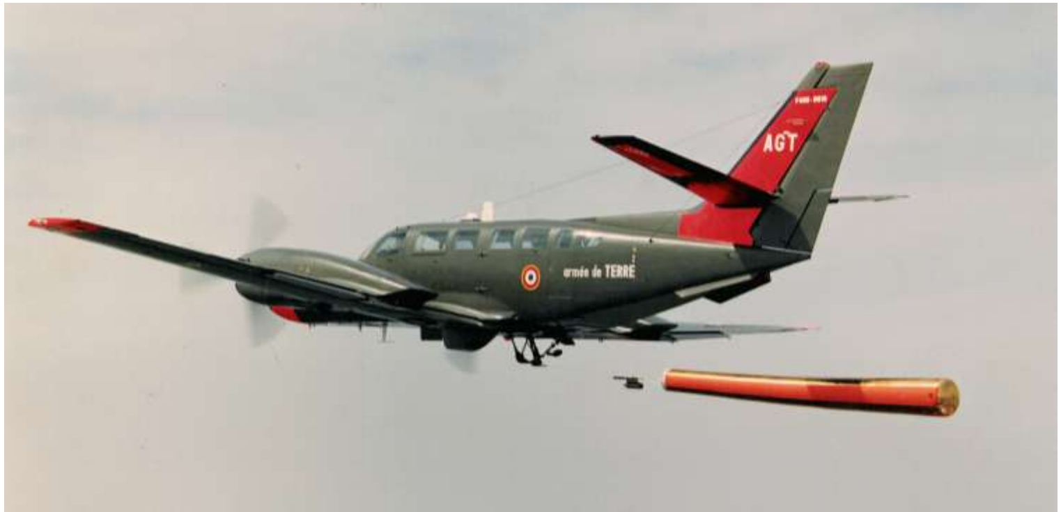
F-406 n° 0010/AGT du 3 e GHL remorquant une manche à air servant de cible (photo CEV, via Christian Malcros).
