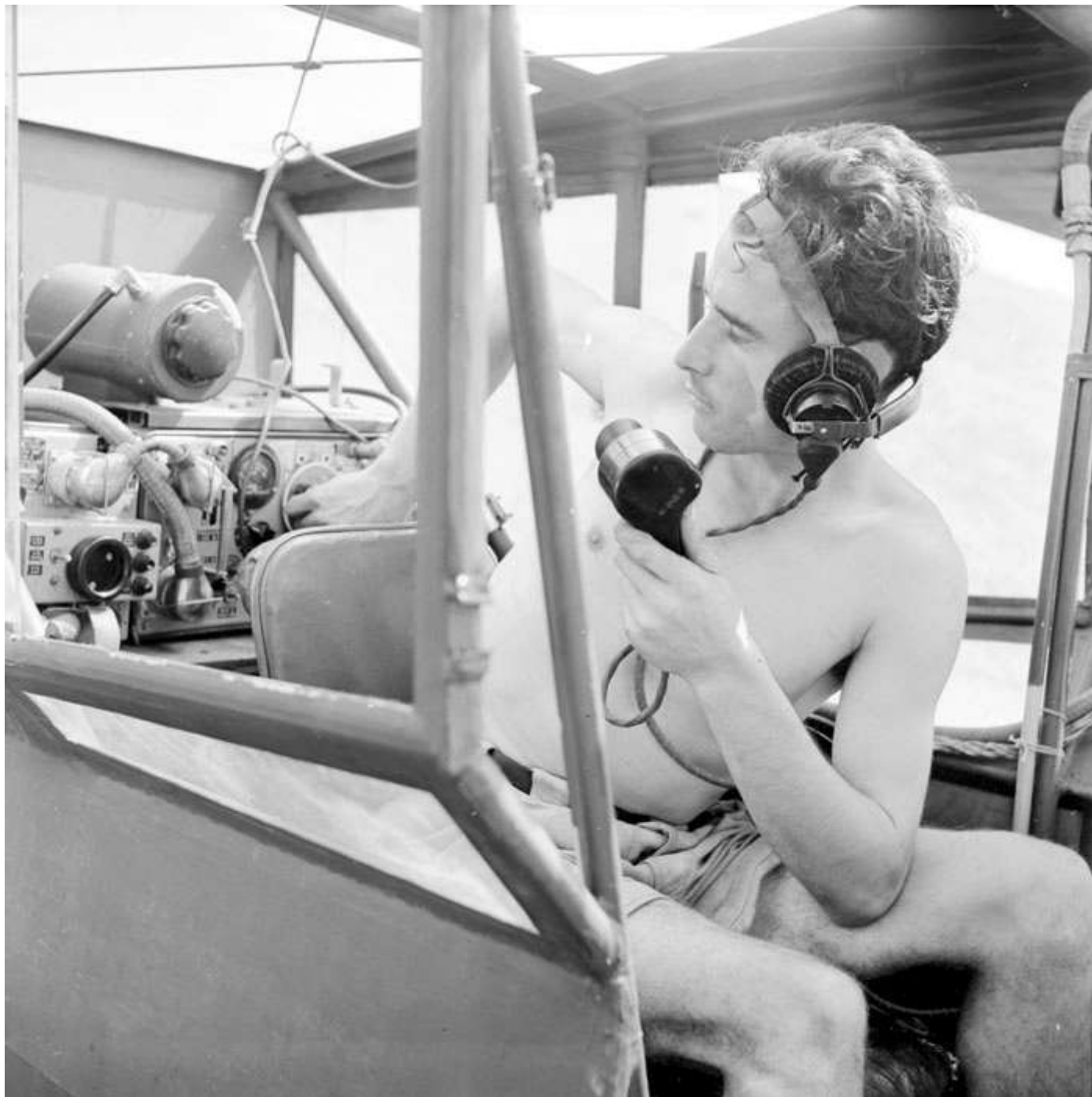
Avant une mission de reconnaissance, un sergent du 22 e GAOA fait une dernière vérification sur la radio de bord d'un Morane-Saulnier MS-500 "Criquet" (photo ECPA).
